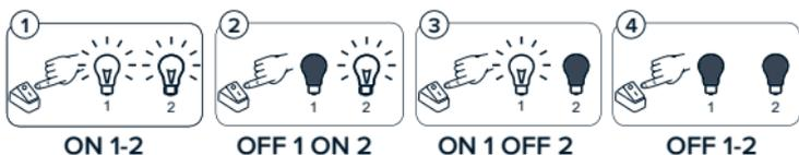
Con le uscite accese, ad ogni pressione lunga (>1 sec) del pulsante filare, le uscite 1 e 2 variano entrambe di intensità luminosa: la prima volta aumentano di intensità, la successiva diminuiscono e così via in modo alternato. Le uscite spente non variano.
