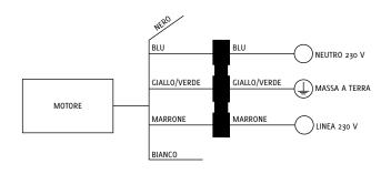
Cablaggio - Motore - Alimentazione
