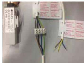
Collegare i cavi del motore alla centralina e quelli della centralina all'alimentazione.
