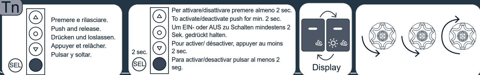
**I** Per evitare modifiche accidentali alla programmazione del motore durante l'uso quotidiano del telecomando, la possibilità di programmazione viene disabilitata automaticamente dopo 8 ore dall'invio dell'ultima sequenza (A+B o B+C).
