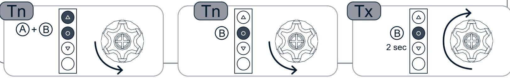
CANCELLAZIONE SINGOLO TELECOMANDO (Tn) - Remote control memory clearing (Tn) - Löschen eines einzelnen Handsenders (Tn)
