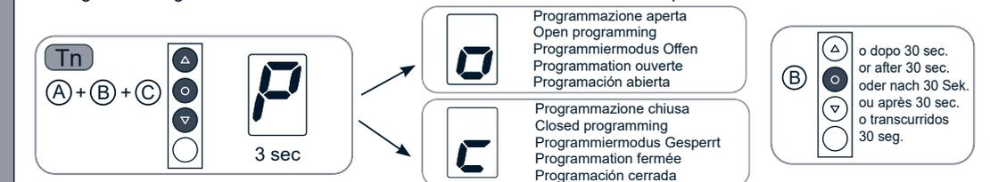
PER MODIFICARE LO STATO DELLA FUNZIONE VEDI LE SEQUENZE ABILITAZIONE/DISABILITAZIONE - To change the status of the function, see the sequences "enable/disable programming" - Zur Änderung des Programmiermodus, "Öffnen/Sperren" wie hier folgend geschildert vorgehen - Pour modifier l'état de la fonction voir les séquences activation/désactivation - Para modificar el estado de la función ver las secuencias habilitar/deshabilitar
